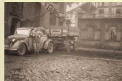
Um den Eifel für die Zwecke der Kohlenhandlung einsetzen zu können, musste eine zusätzliche Schleppachse untergebaut werden, welche die Antriebskraft des gasbetriebenen Motors mit zwei Gliederketten übertragen bekam. Mit diesem Fahrzeug und einem auf Panzerrädern
